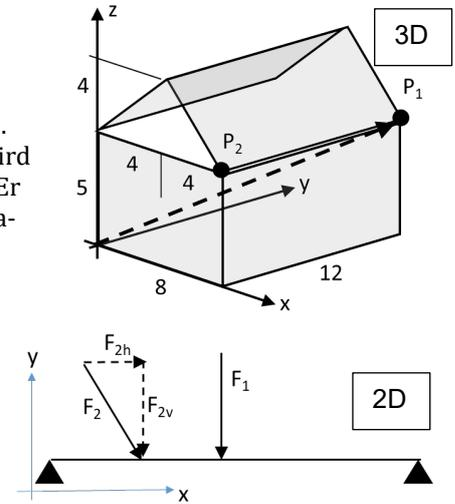
*Vorsicht:* In der Mathematik ist ein Vektor (parallel) verschiebbar, in der Physik bzw. Mechanik nicht. Die Position einer einwirkenden Kraft darf nicht verändert werden – ansonsten wird das mechanische System verändert.
